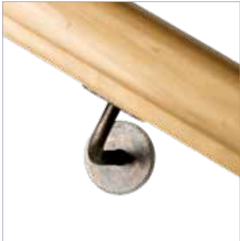
LH-01 afwerking: staal, onbehandeld bevestiging: stokbout, m8 zadel: vlak gewicht: 0,25 kg afmeting: Ø 60 x 81 mm
