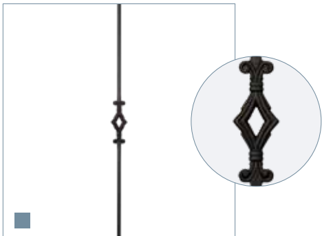
MV-11 HOL afwerking: gepoedercoat, mat zwart lengte: 970 mm doorsnede: 12,7 mm gewicht: 0,47 kg afmeting sierwerk: 56 x 152 mm (bxh)
