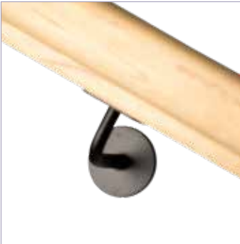
LH-02 afwerking: staal, mat zwart bevestiging: stokbout, m8 zadel: vlak gewicht: 0,25 kg afmeting: Ø 60 x 81 mm
