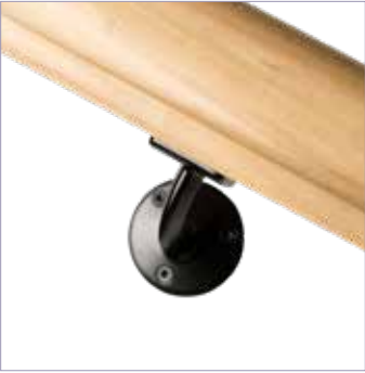
LH-06 afwerking: aluminium, mat zwart bevestiging: opschroevend zadel: vlak gewicht: 0,06 kg afmeting: Ø 56 x 65 mm
