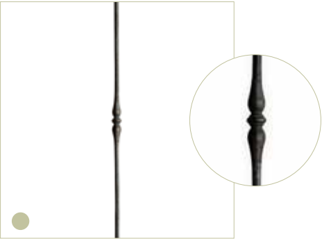
S-20 afwerking: warmgesmeed lengte: ±1.040 mm doorsnede: Ø 12 mm gewicht: 1,06 kg afmeting sierwerk: 25 x 100 mm (bxh)
