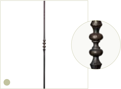
S-02 afwerking: warmgesmeed lengte: ±1.040 mm doorsnede: Ø 12 mm gewicht: 1,07 kg afmeting sierwerk: 26 x 85 mm (bxh)
