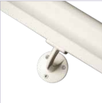
LH-08 afwerking: aluminium, wit bevestiging: opschroevend zadel: vlak gewicht: 0,06 kg afmeting: Ø 56 x 65 mm
